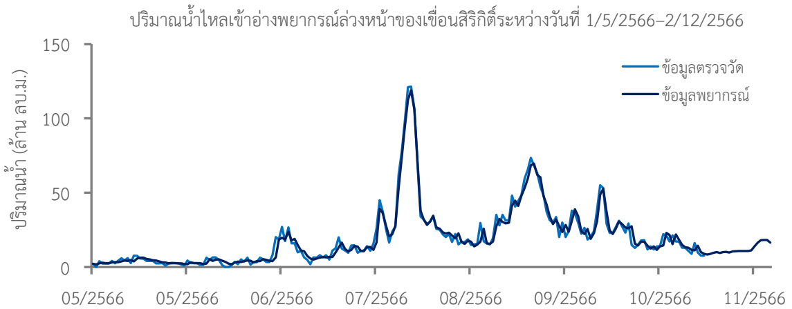
ภาพที่ 4-56 ปริมาณน้ำไหลเข้าอ่างพยากรณ์ล่งหน้าของเขื่อนสิริกิติ์ระหว่างวันที่ 1/5/2566-2/12/2566
