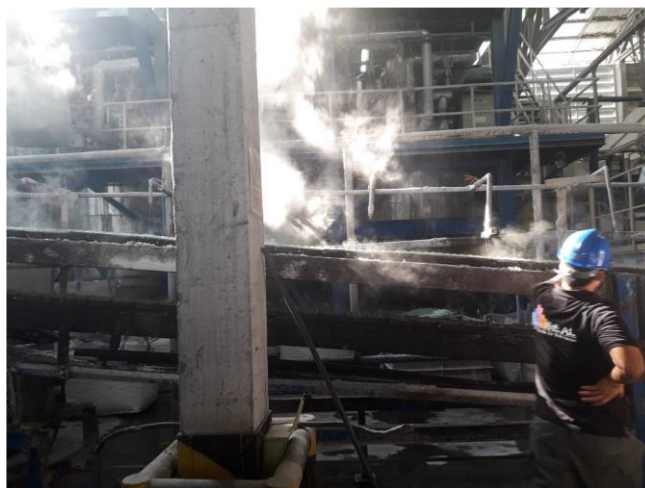
รูปที่ 3-110 ขั้นตอนการใช้น้ำหยดลดอุณหภูมิของ Sodium Silicate ของบริษัท ไทยซิลิเกตเคมีคัล จำกัด
