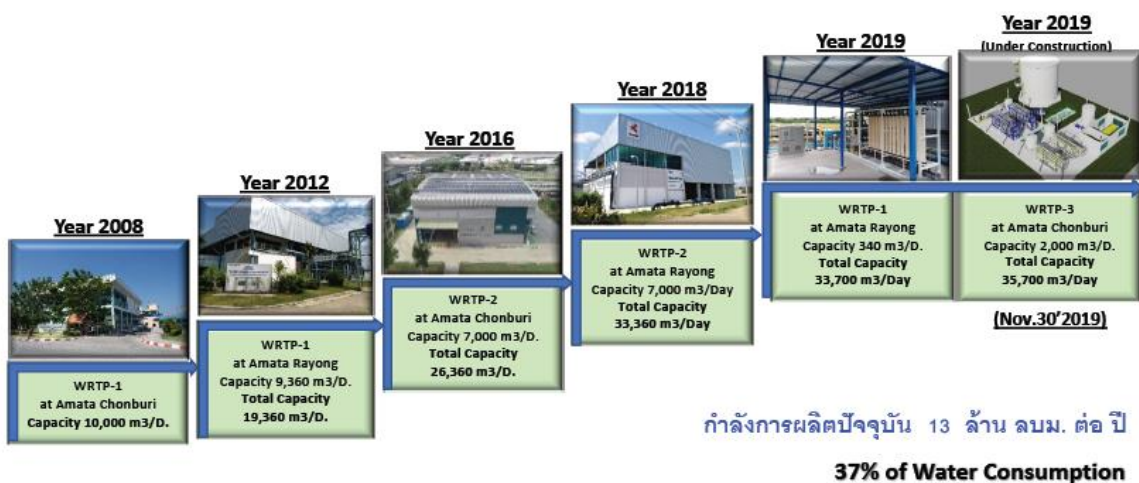
รูปที่ 3-3 การผลิตน้ำประปาจากน้ำเสียที่ผ่านการบำบัดของนิคมอุตสาหกรรมอมตะซิตี้ ชลบุรี
