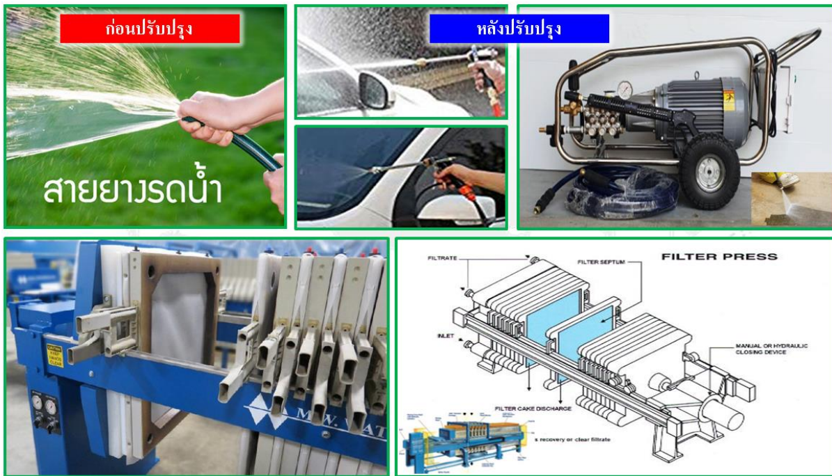
รูปที่ 3-78 ขั้นตอนการล้างเครื่อง Filter Press ด้วยเครื่องฉีดน้ำแรงดันสูงของบริษัท โมเตอร์น ไคสตัดส์ แอนด์ พิคเมนท์ส จำกัด
