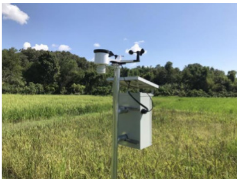
รูปที่ 3.1-4 สถานีตรวจวัดสภาพอากาศผ่านเครือข่ายไร้สาย
