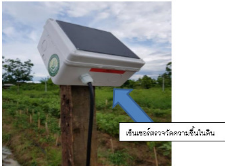
รูปที่ 3.1-2 จุดติดตั้งเซ็นเซอร์ตรวจวัดความชื้นในพื้นที่แปลงปลูก
