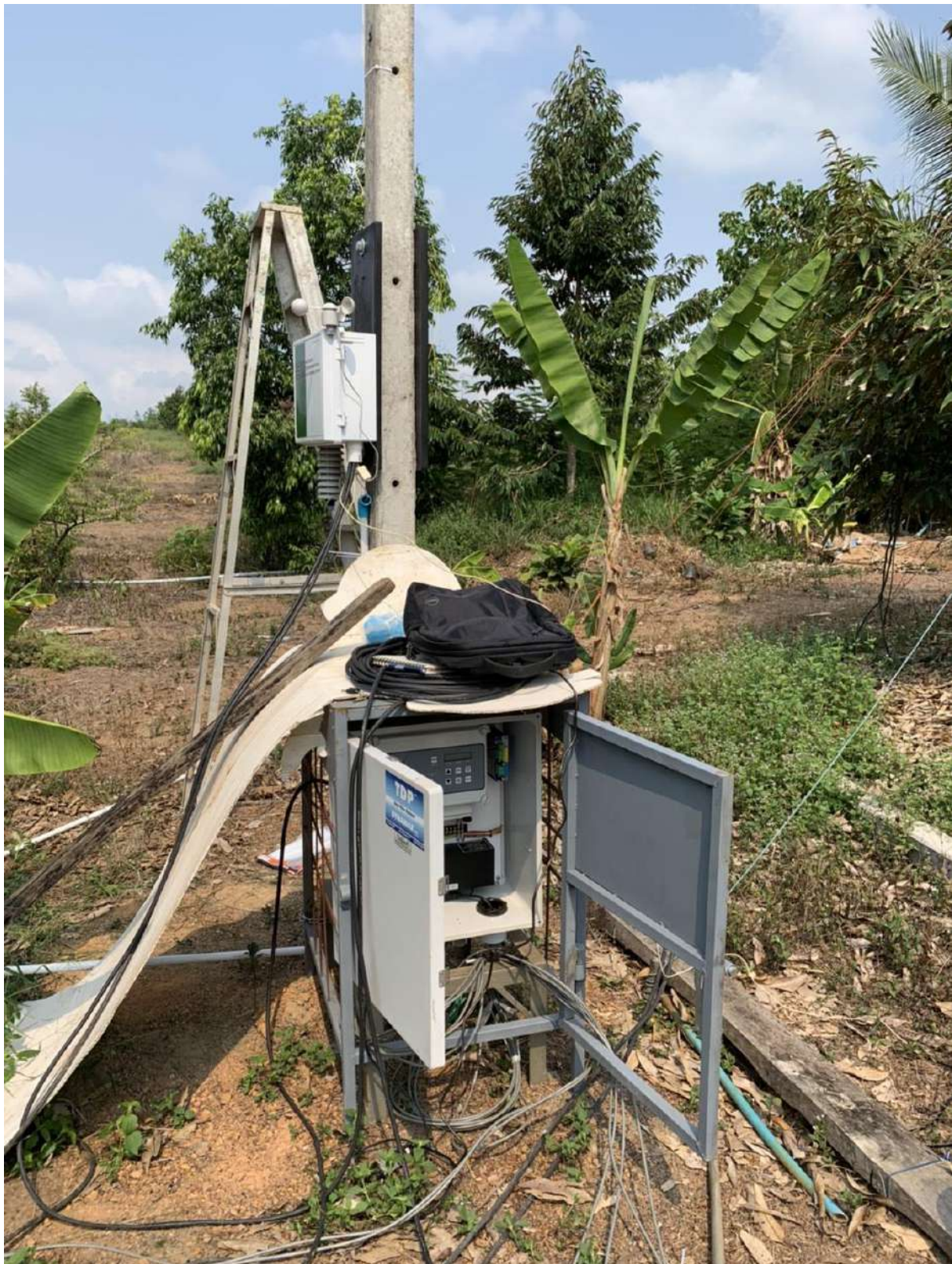
รูปที่ 3-5 สถานีตรวจวัดข้อมูลสภาพภูมิอากาศ และเครื่องมือวัดปริมาณน้ำที่พืชดูดไปใช้ อำเภอเมือง จังหวัดตราด
