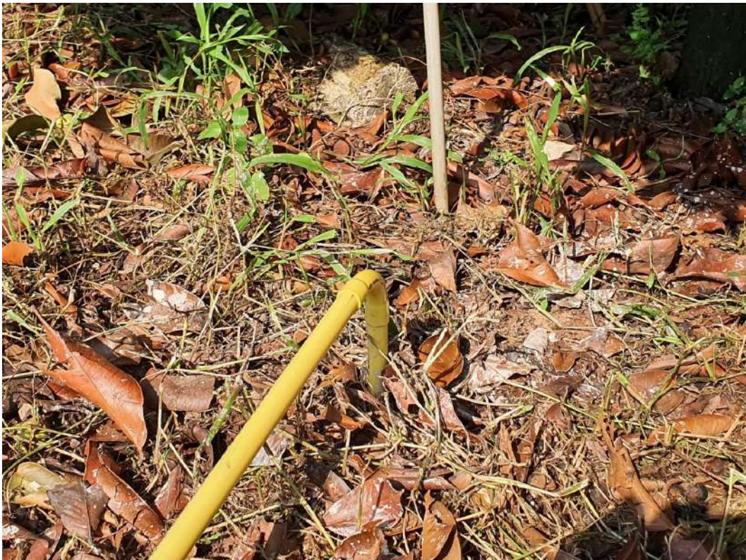
รูปที่ 3-7 การติดตั้งเซนเซอร์วัดความชื้นในดิน อำเภอเมือง จังหวัดตราด
