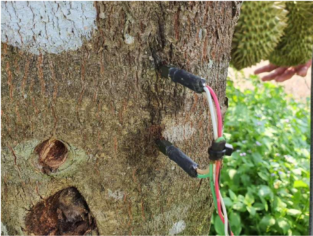
รูปที่ 3-6 เข็มวัดปริมาณน้ำที่พืชดูดไปใช้ (sap flow) อำเภอเมือง จังหวัดตราด
