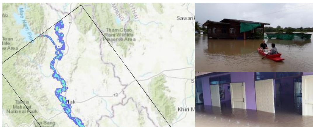
รูปที่ 4.3.2-4 การเปรียบเทียบความลึกน้ำท่วม พ.ศ.2560 ในลุ่มน้ำปิงจากแบบจำลอง Nays2DFlood กับที่เกิดขึ้นจริง
