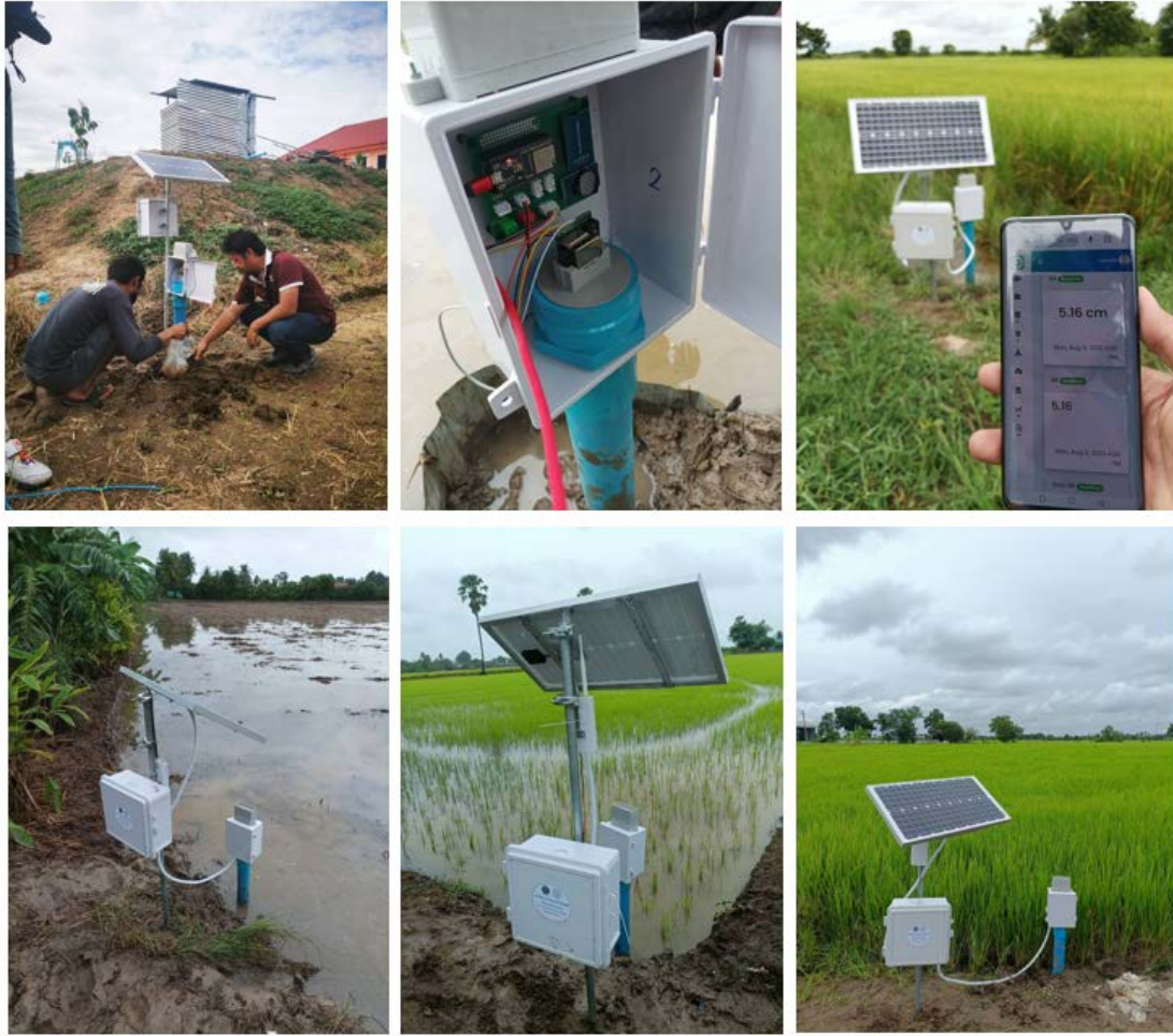
รูปที่ 6.3-9 จุดติดตั้งอุปกรณ์วัดระดับน้ำในแปลงนา
