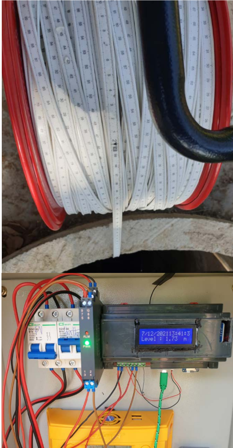
รูปที่ 5.2-13 การทดสอบการวัดระดับน้ำบาดาล
