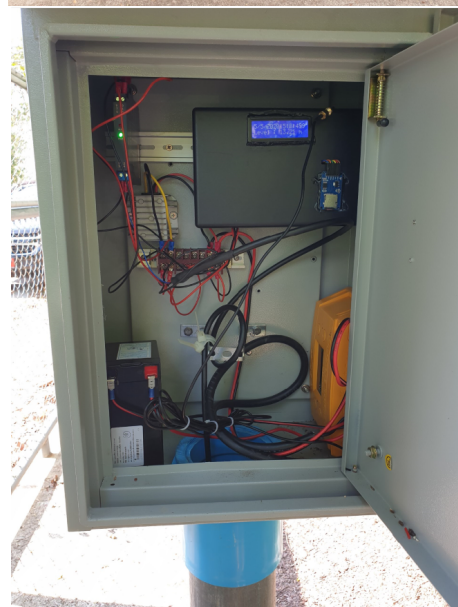
รูปที่ 7 การติดตั้งเครื่องวัดระดับน้ำบาดาลและบันทึกข้อมูลอัตโนมัติ
