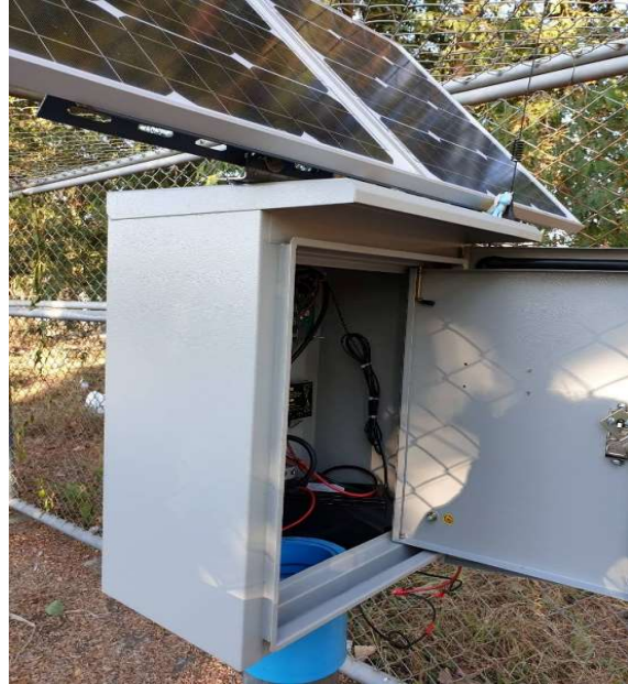
ภาพที่ 2 การเตรียม BOARD ของ IoT ที่จะติดตั้งรับข้อมูลจาก Probe
