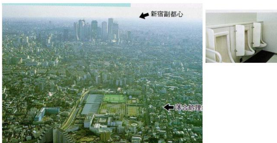
รูปที่ 4.5 การนำน้ำกลับมาใช้ใหม่เป็นน้ำซักโครกในย่านชินจูกุ โตเกียว (Suzuki et al., 2002)
