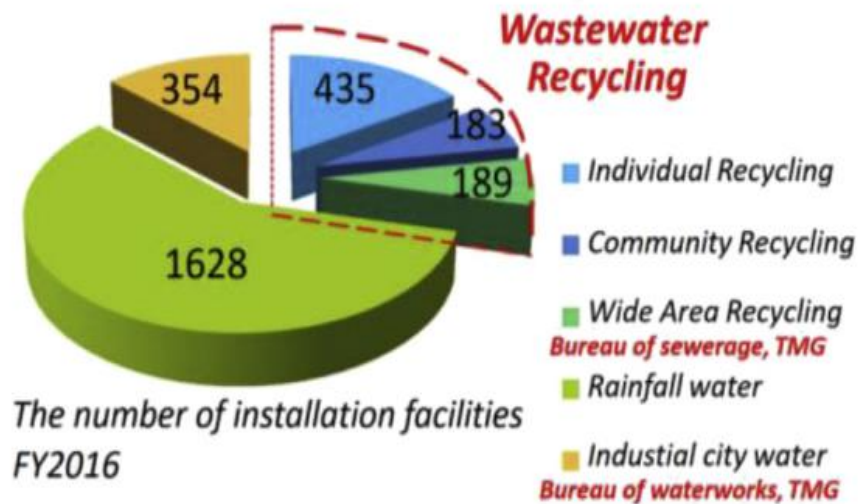
รูปที่ 4.6 รูปแบบและจำนวนของระบบรีไซเคิลน้ำในกรุงโตเกียว (Takeuchi and Tanaka, 2020)
