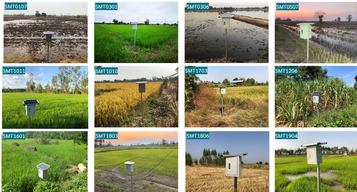
รูปภาพ แสดงการติดตั้งเครื่องมือวัดความชื้นดิน
